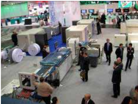
図 : Truepress JET520 による新聞出力のデモ
